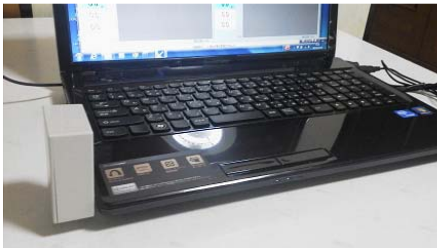
図 9： 親機を制御用パソコンに装着した状態
