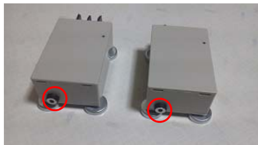
図 2：ビートルの電源供給端子
